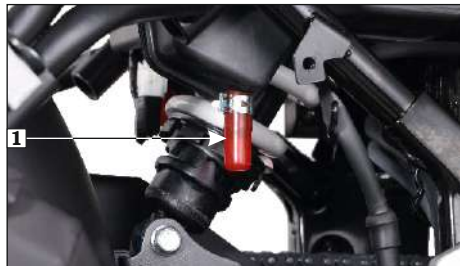
(1) Tubo de drenaje
