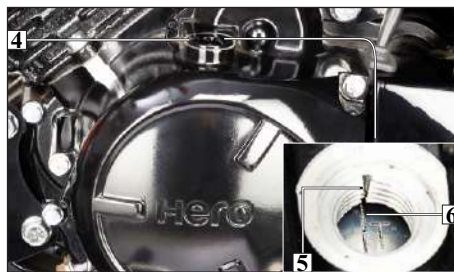
(4) Tapa del orificio del temporizador (5) Marca "T" (Tiempo) (6) Marca de referencia
