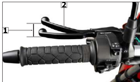
(1) Movimiento 10-20 mm (2) Palanca de embrague
