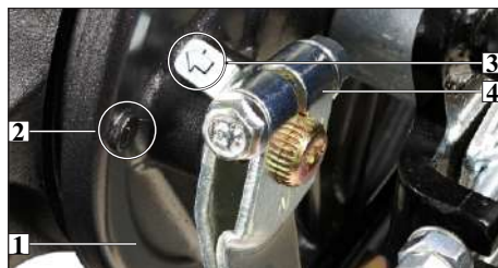
(1) Panel de Freno (2) Marca de referencia (3) Flecha (4) Brazo de freno
