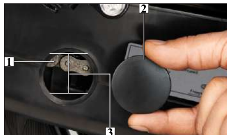
(1) Cadena de arrastre (2) Tapón del orificio (3) Holgura de la cadena de 25 mm (aprox.)
