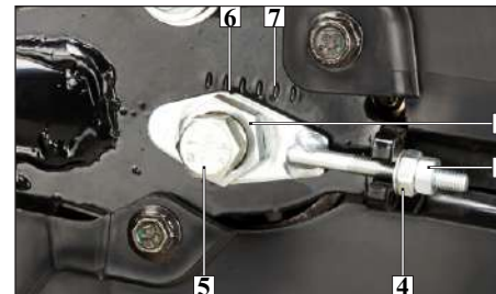
(2) Casquillo (3) Tuerca de unión de la cadena (4) Tuerca de ajuste de la cadena (5) Eje trasero (6) Marca de referencia (7) Graduación en escala
