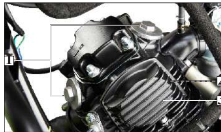
(1) Tapas de la válvula (2) Empaque (3) Cubierta del lado izquierdo de la cabeza del cilindro
