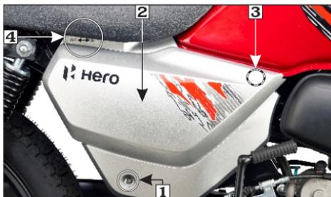
(1) Tornillos cubierta (2) Cubierta lateral
