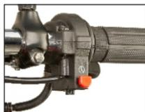
6. Abra ligeramente el acelerador y presione el interruptor de arranque (Alternativamente, se puede usar el pedal de patada para arrancar).
