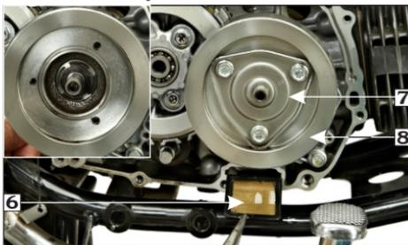
(6) Malla filtro de aceite (7) Cubierta filtro centrífugo
