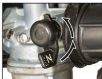
5. Empuje la perilla del arranque hacia abajo a la posición "ON" como se indica (utilice el choque en condiciones de frío).
