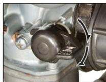
7. Tire de la perilla del arranque hacia arriba hasta la posición "OFF" como se indica, después de que el motor se haya calentado lo suficiente como para tener una respuesta estable del acelerador.
